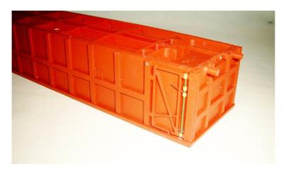
Splinte mit aufgeschobener Hülse (als Abstandbuchse) werden verwendet als Halterung von den Entlüftungsgestängen und in die Seitenwände geklebt.
